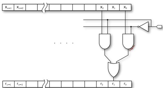
En cuanto a los operadores sintetizados en VLSI, tenemos el *barrel shifter*.
